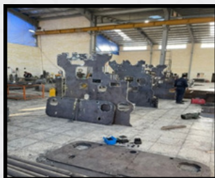
شکل-۱- خط تولید ژاکارد ماشین های بافندگی فرش واندویل
